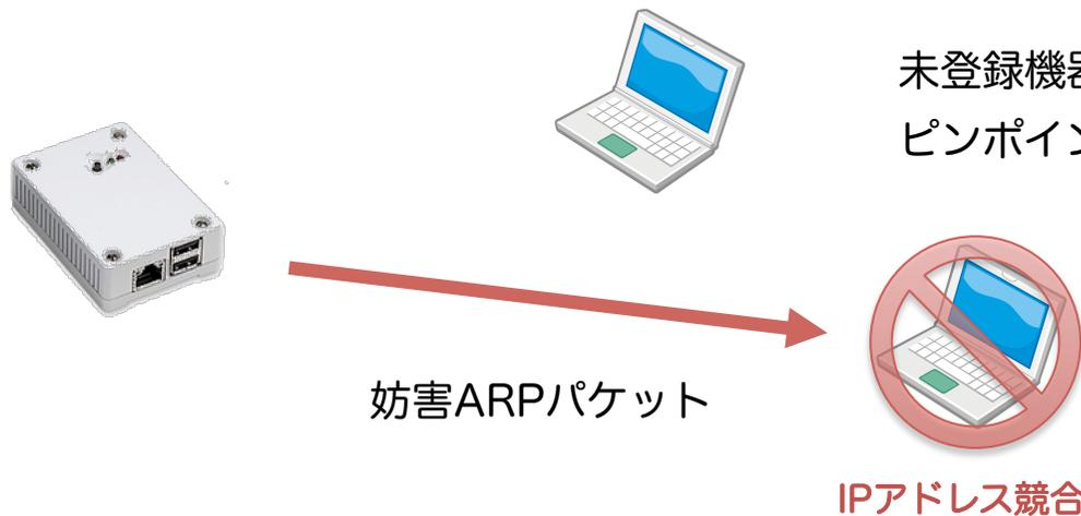
未登録機器に対し妨害ARPパケットを送出しピンポイントで通信を遮断します。
